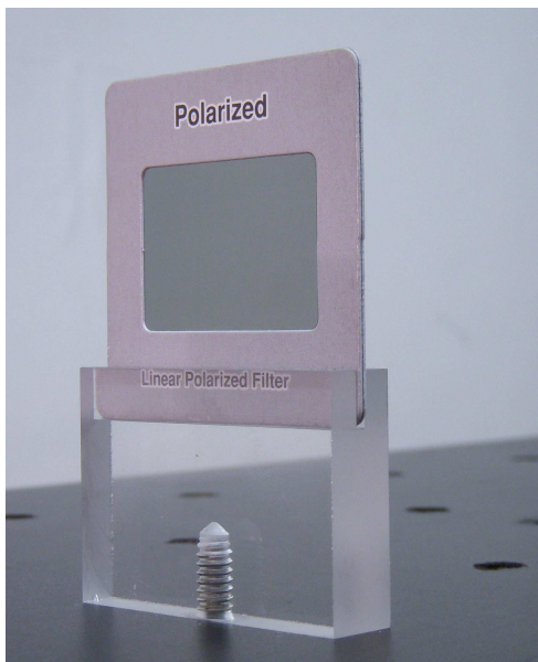
P olaryzator zamontowany w oprawce wsuwanej w akrylową podstawką (etykieta J).
